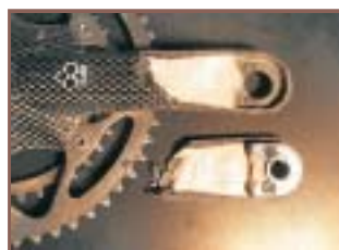
傳統發泡成型破壞情形
